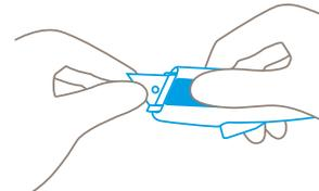
Bewegen Sie den Schieber ganz nach vorn und drehen Sie den Griff, sodass die **transparente Klappenabdeckung nach oben** zeigt.
